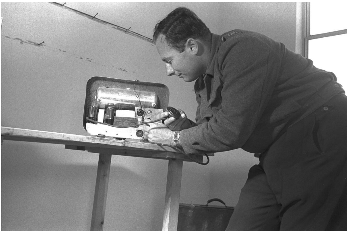
נפתלי (נפתא) רז (רייזר) עם משדר חשאי מוסלק בתנור חימום ביתי. המכסה מורם וניתן לראות את המשדר. השנאי הגדול במרכז הוא שנאי האפנון. אוסף התצלומים הלאומי D381-027
