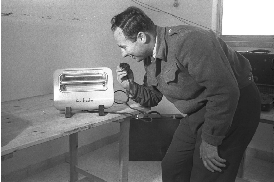
נפתלי (נפתא) רז (רייזר) מדגים שידור ממשדר חשאי מוסלק בתנור חימום ביתי. המיקרופון הוא מיקרופון פחמי מטלפון בריטי. אוסף התצלומים הלאומי D381-029
