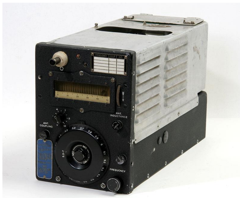
משדר BC-458, המכונה גם T-21/ARC5 צילומים: PA3ESY
