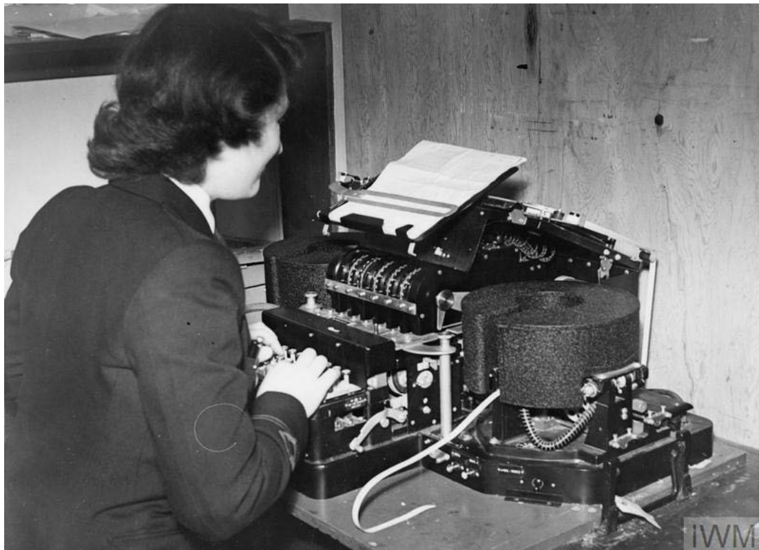
הפעלת מכונת TypeX Mark II עם מתאם CCM באדיבות Imperial War Museum, A 23510
