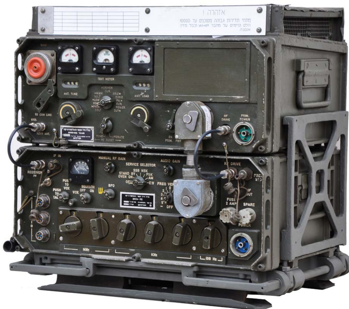
מקלט-משדר ת"ג חד-פס מק-106 – מקלט-משדר מח-834 ומגבר הספק ומתאם אנטנה מח-3349
