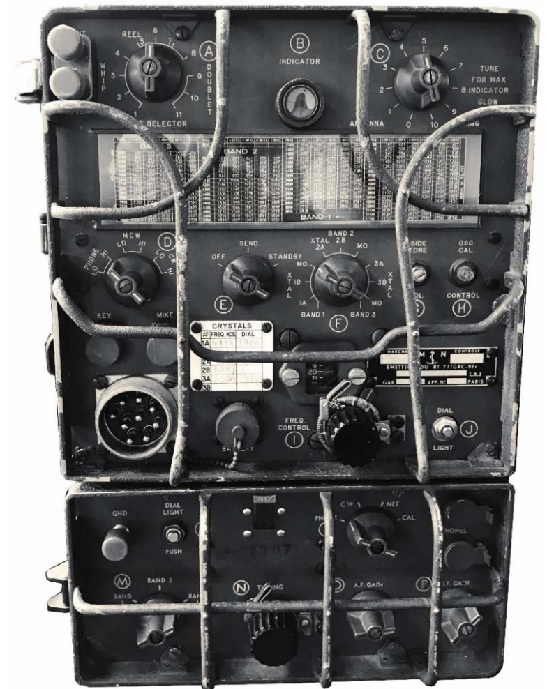
מכשיר קשר ת"ג נישא 109-מק מכשיר ייחודי לצנחנים, שהופעל בידי צוות של שלושה מפעילים
