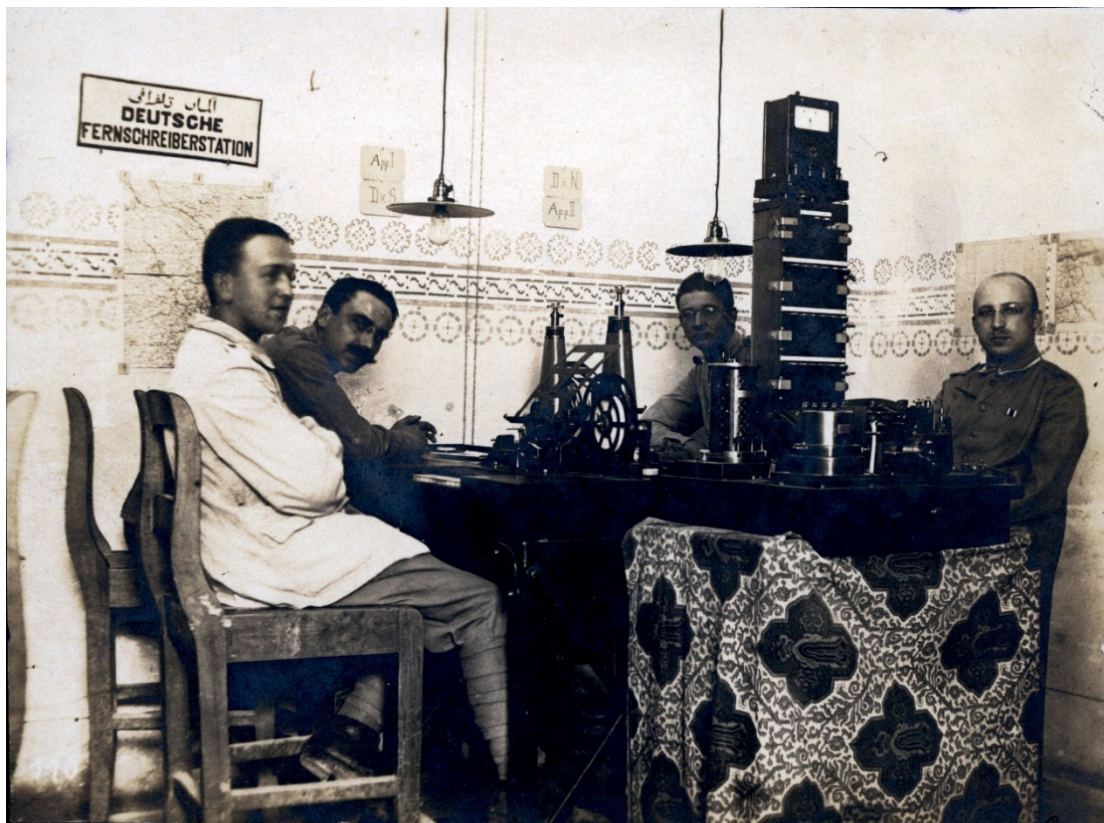
תחנת הטלגרף, מפקדת קבוצת ארמיות ילדרים, נצרת, 1918 על השולחן: מספר עמדות טלגרף ידניות ושתי מכוונות טלגרף מדפיסות (Hughes printing telegraph) סינכרוניות תוצרת Siemens & Halske באדיבות הארכיון הציוני המרכזי, PHG\1003634
