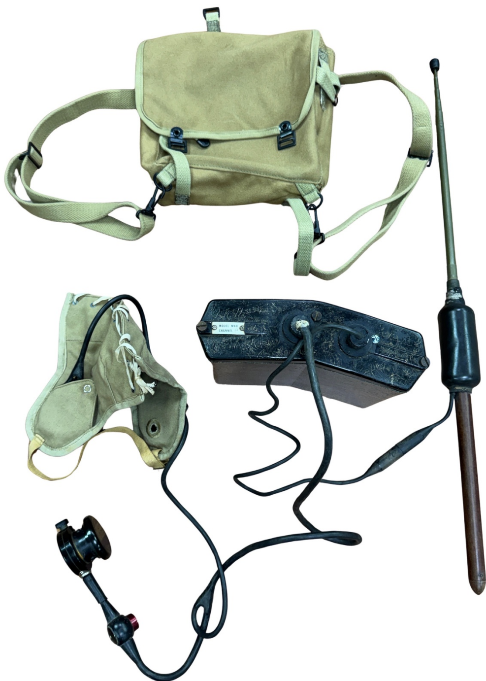
מרכיבי מק-21: משדר־מקלט, מיקרופון, אזניות במעטה בד, אנטנה, תיק נשיאה
