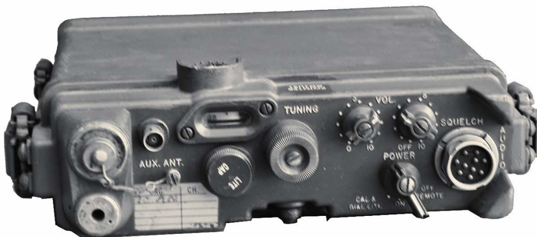
מילואת מקמ"ש תג"ס מק-9/מק-10 למחבר הקואקסיאלי ניתן היה לחבר אנטנה מסוג אנ-1292 ('ספוטניק')
