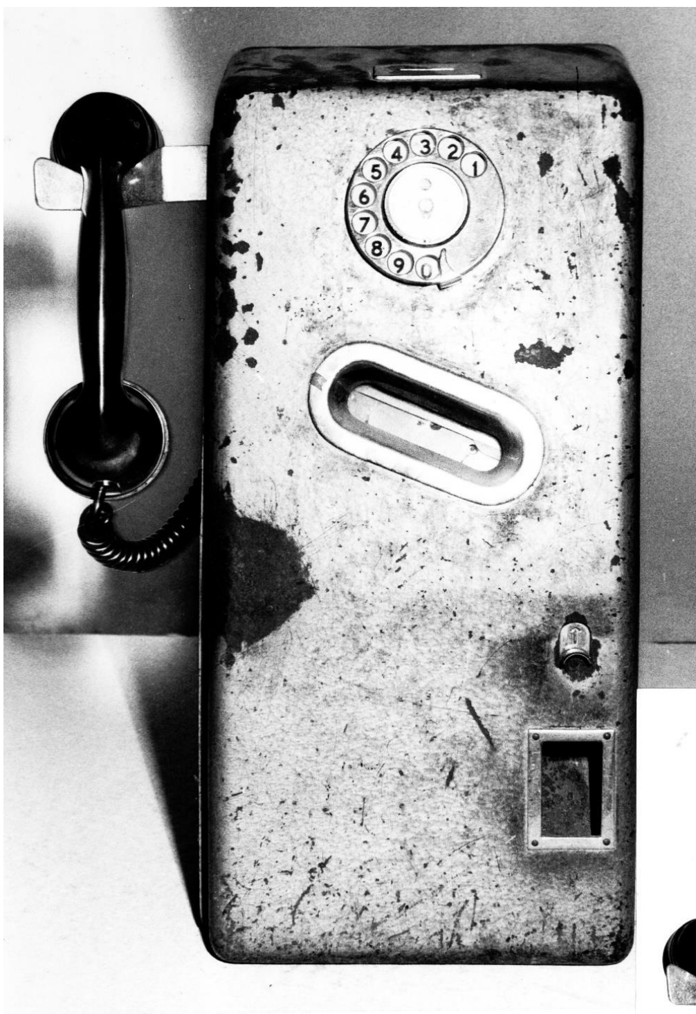
הדגם הראשון של טלפון ציבורי 605 פותח במשרד הדואר בשנת 1962 מקור: משרד התקשורת, בית המלאכה המרכזי, חיפה, תשל"א – 1971
