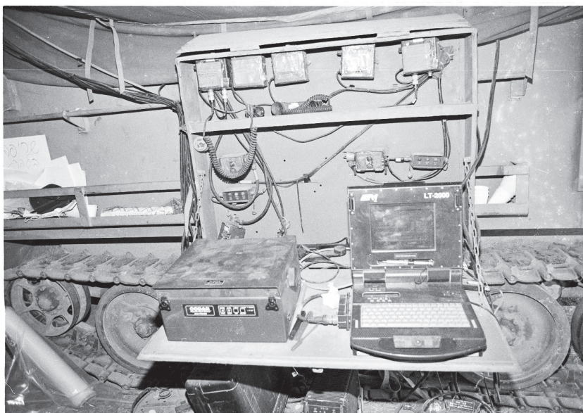
תחנת קצה מוקשחת במערכת 'אורות הבמה' - פריסת שדה על דופן נגמ"ש מחשב נייד מוקשח EFW ומדפסת מוקשחת 8240 מקור: אוסף העמותה להנצחת חילי חיל הקשר והתקשוב
